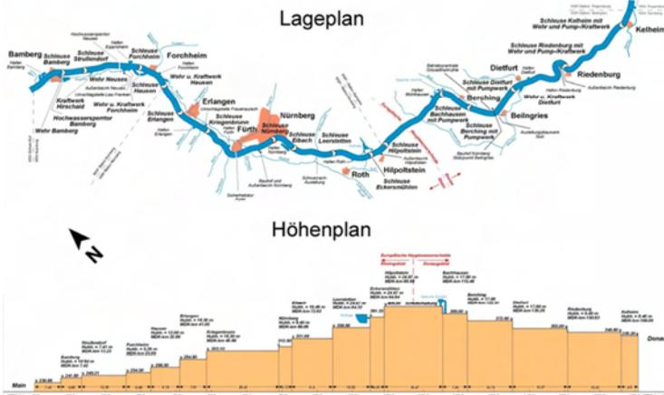
Bild 2: Lage- und Höhenplan MDK, WSA Nürnberg)
